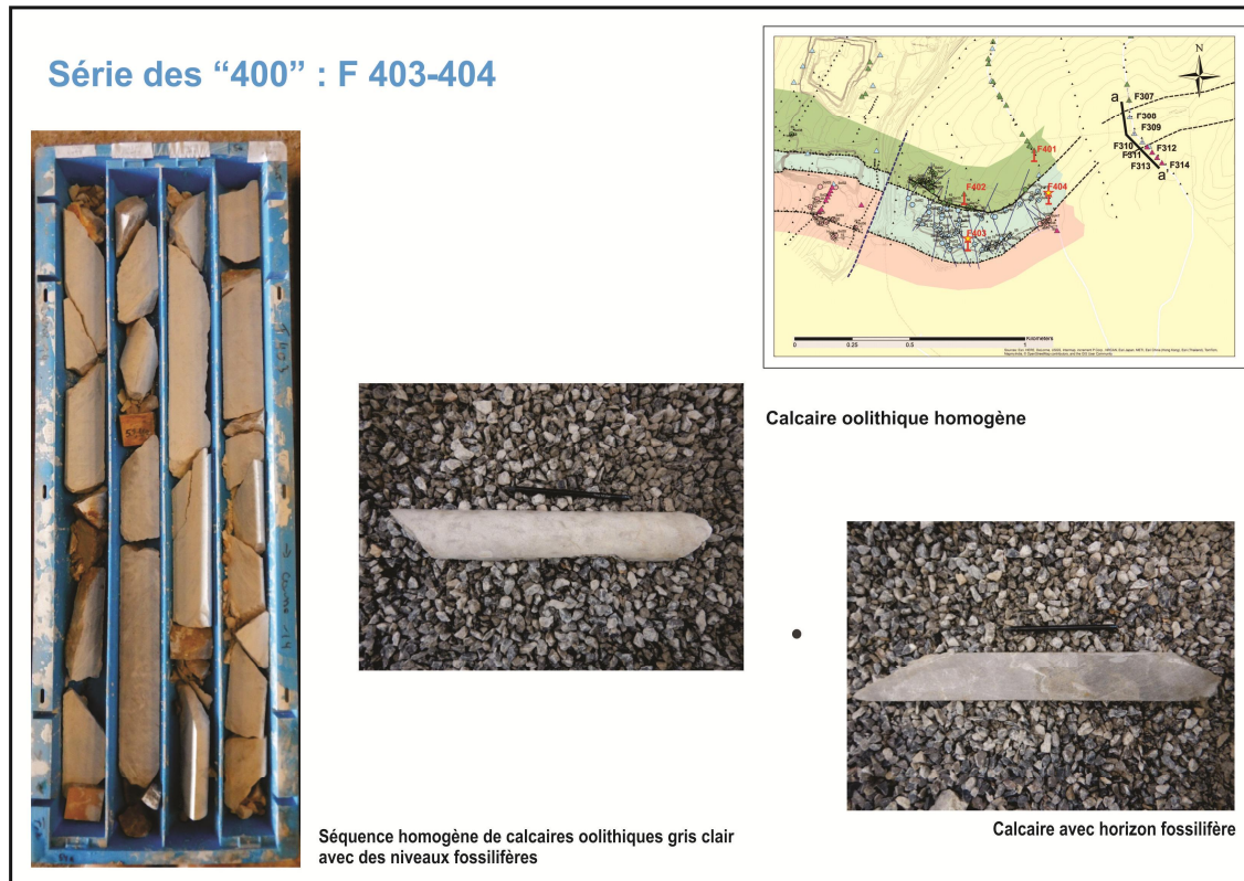
Figure 24: Localisation et description des sondages F403- F404
