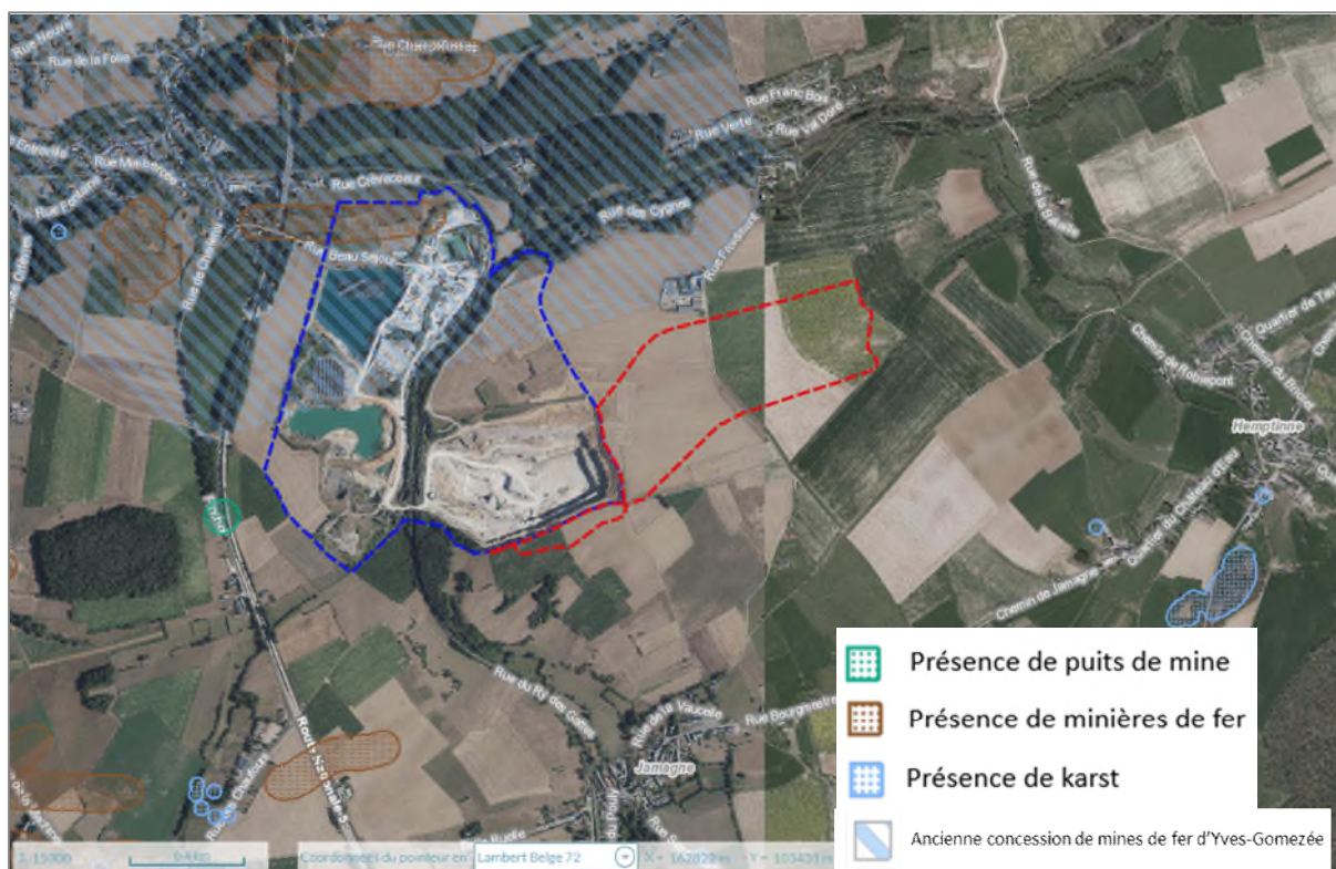
Figure 214 : Consultation des banques de données pour ce qui est d'éventuelles cavités souterraines répertoriées (WalOnMap, 2023)
