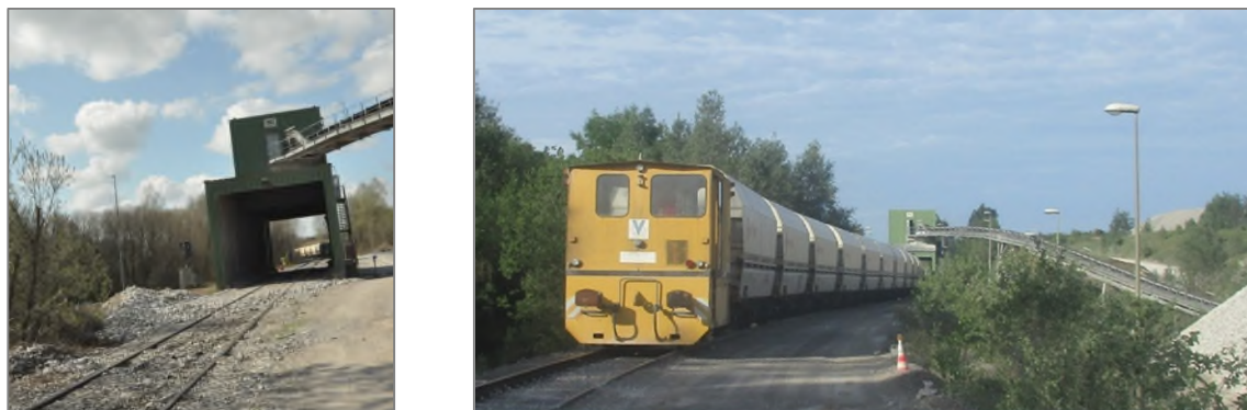
Figure 164 : Vue sur la zone de chargement des wagons et la locomotive radiocommandée utilisée (ARIES, 2023)
