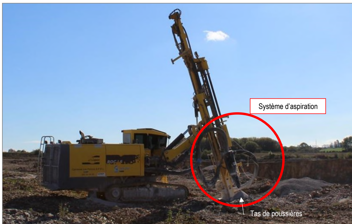
Figure 329 : Vue sur la foreuse de type Copco ROC L6 (ARIES, 2018)
