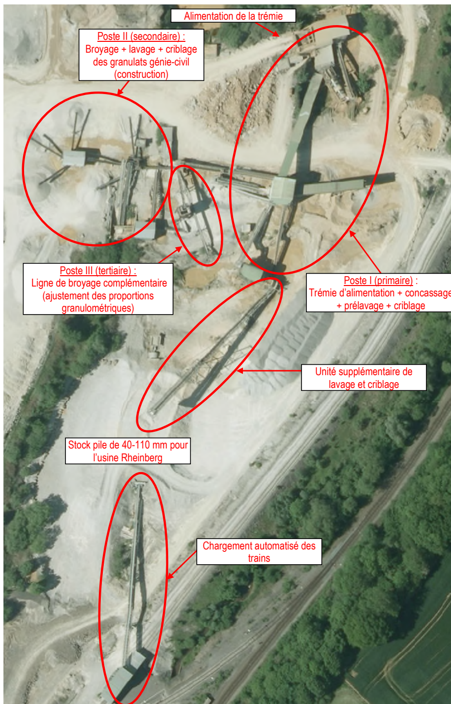
Figure 356 : Description de la ligne de production principale (ARIES, 2019)
