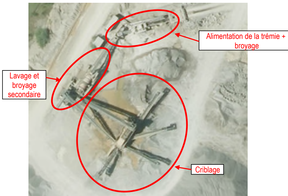
Figure 357 : Illustration de la ligne de production quaternaire (calcaire basse teneur) (ARIES, 2019)
