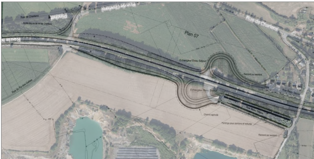
Figure 138 : Réaménagement des bretelles d'accès entre la rue Beau Séjour et la N5 (ARIES, 2023)
