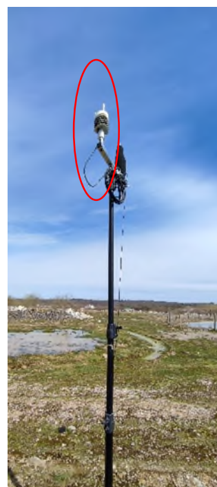
Figure 361 : Station météorologique WXT536 en place au point LD04 (photo de droite) (ARIES, 2023)
