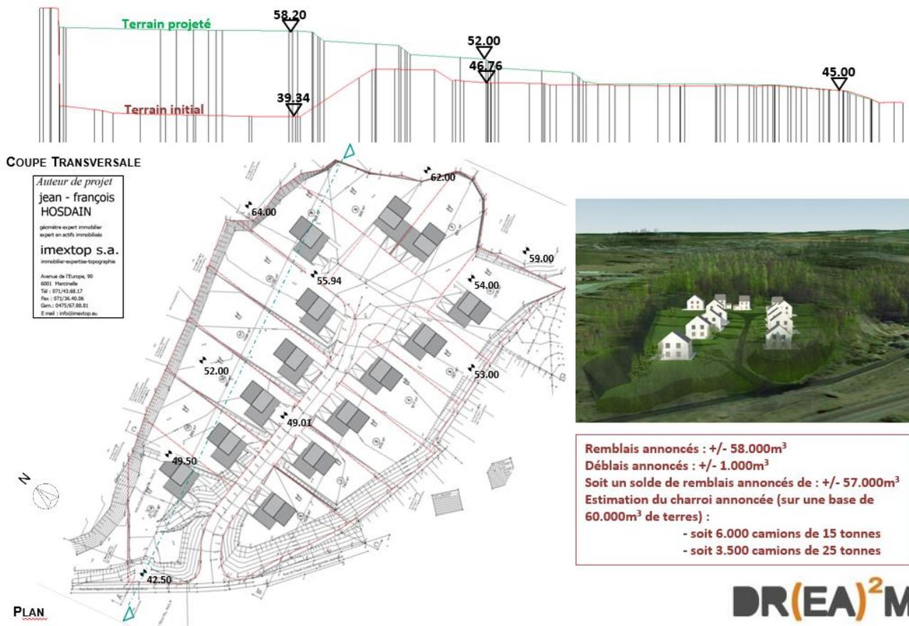
Figure 46 Coupe transversale du projet de modification du relief (Source : DREAM, 2019)
